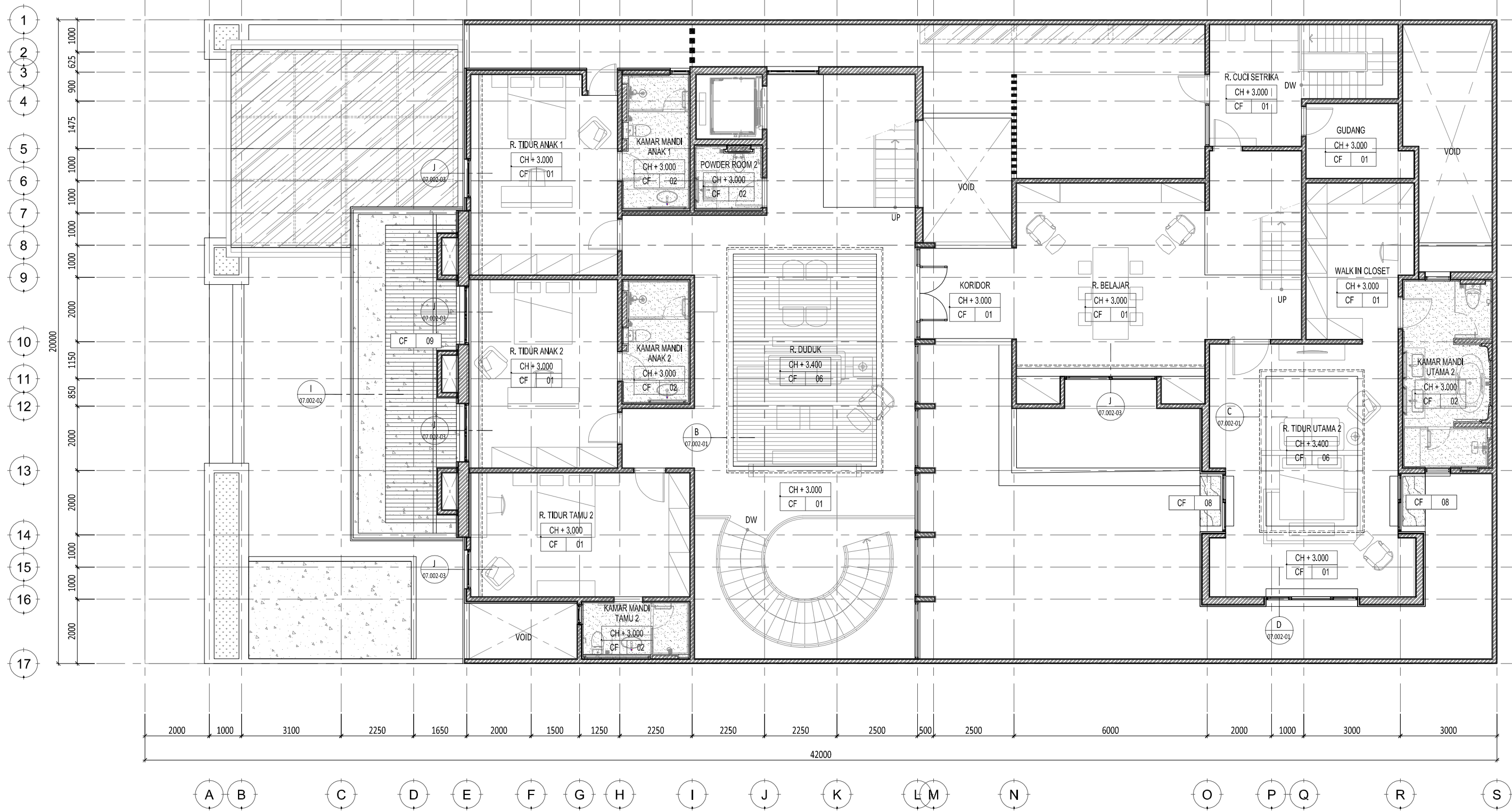
1 DENAH PLAFON - LANTAI ATAS SCALE 1: 125 (A3)
